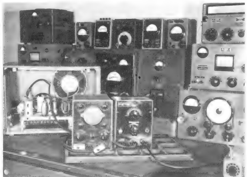
Bild 8. Der Frequenzwobbler mit Meßsender, Oszillograf und Superhet, am Meßplatz betriebsfertig zusammengeschalet
